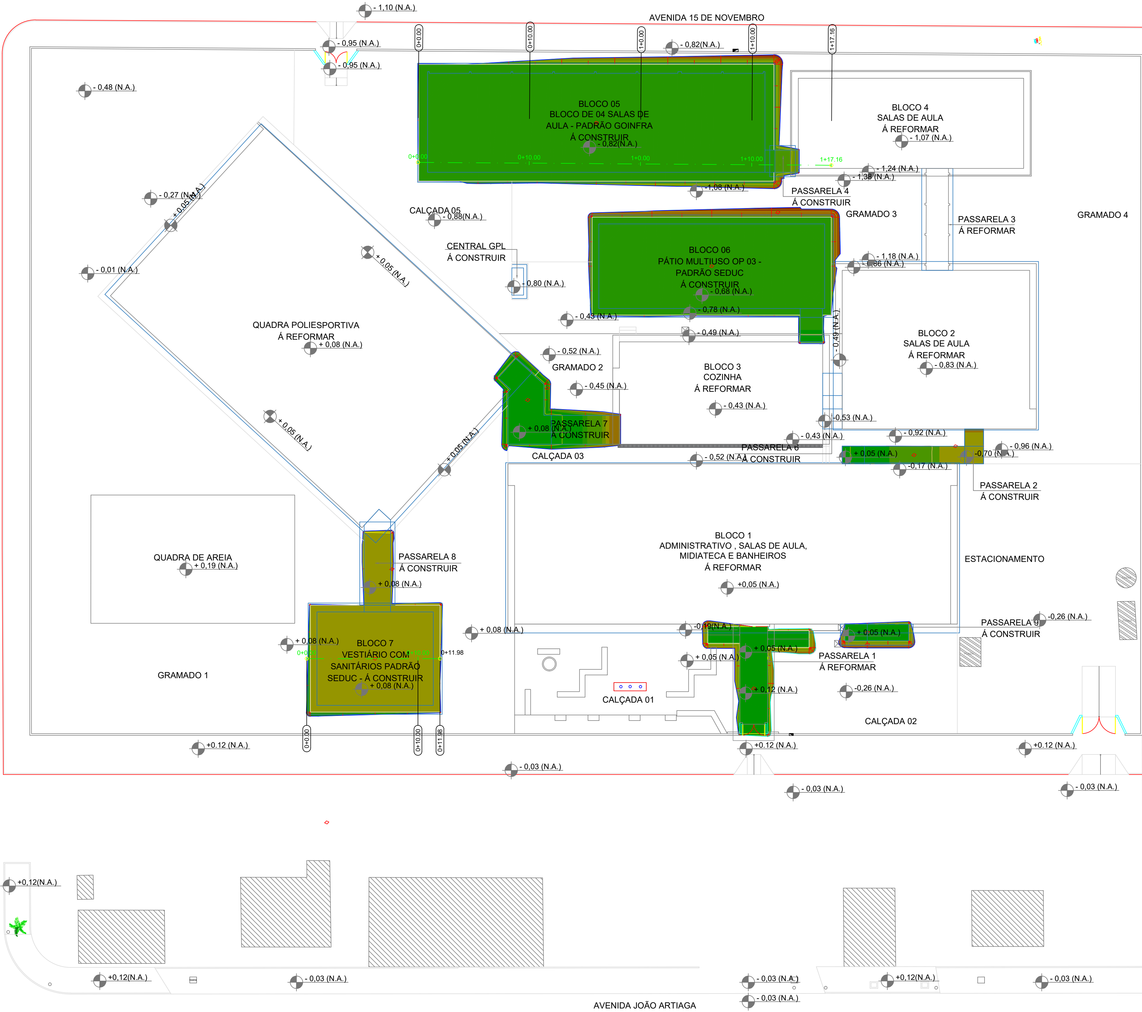
PLANTA DE IMPLANTAÇÃO DOS PLATÔS DA EDIFICAÇÃO ESCALA: 1:200
